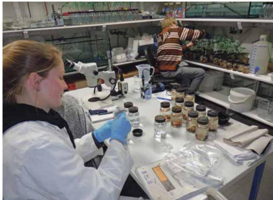
Vorbereitung eines Versuchs mit Bachflohkrebsen zur vergleichenden Bewertung unterschiedlicher Verfahren der vierten Reinigungsstufe an Kläranlagen. Fotos: Institut für Ökologie, Evolution u. Diversität
