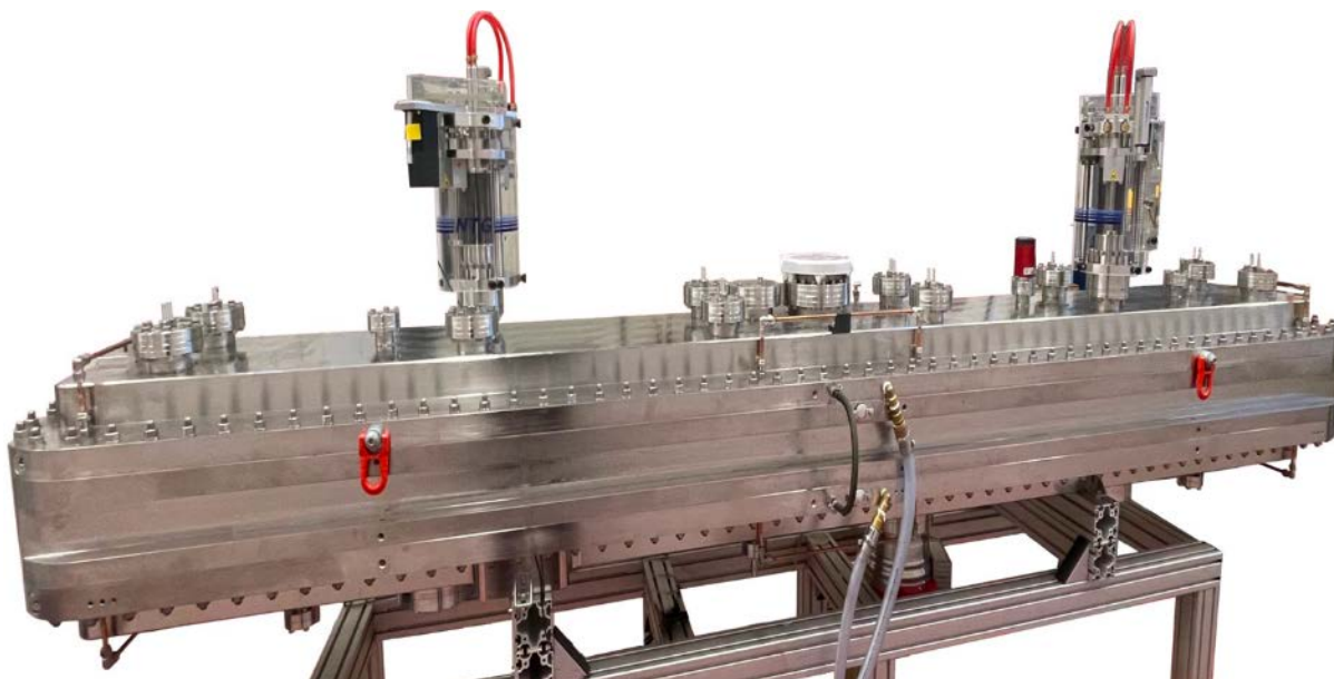
Abb. 24: Leiter-RFQ nach finaler Montage der Vakuumkomponenten, statischer und motorbetriebener Tuner, sowie des Kühlsystems.
