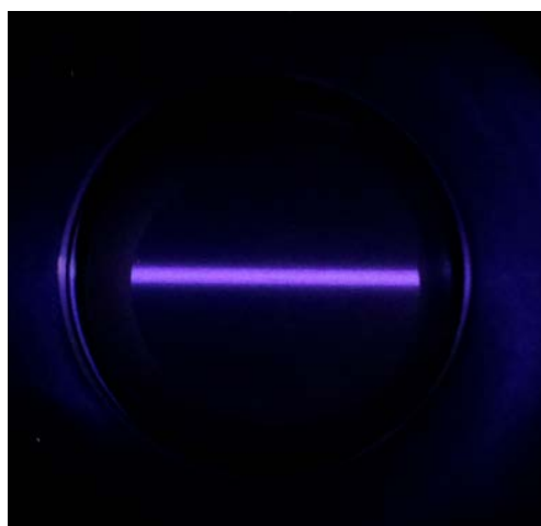
Abb. 29: Optische Aufnahme des transmittierenden Ionenstrahls (Aufnahme von Dr. Adem Ates).
