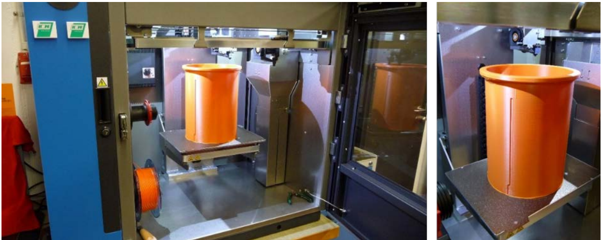
Abb. 34: Druck von einem Segment eines dreifachen Teleskopes mit den Maßen: \varnothing 230 \times 285\text{mm} .
