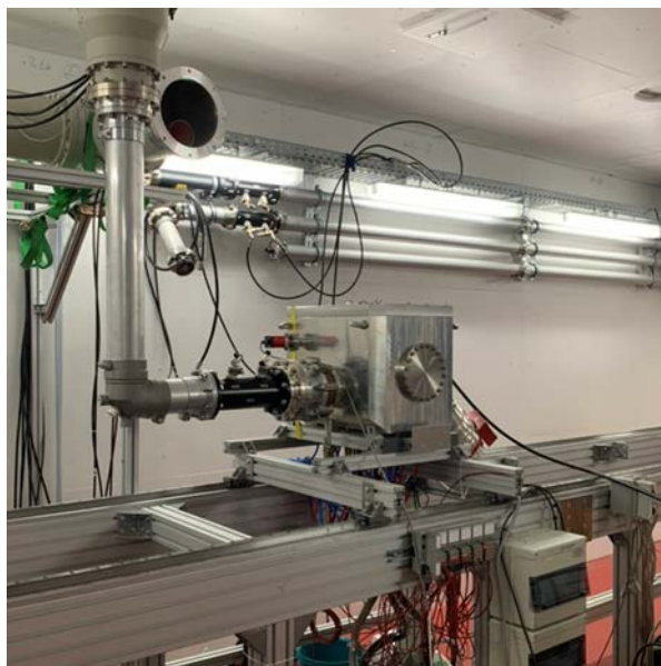
Abb. 9: Teststand des RFQ Prototyps im FRANZ-Bunker.
