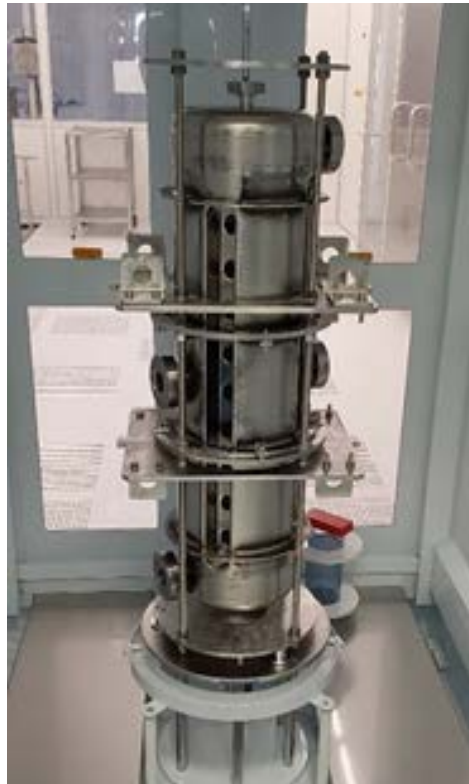
Abb. 13: Vorbereitung des 360 MHz CH-Prototyps für das High-Pressure Rinsing am Helmholtz Institut Mainz.
