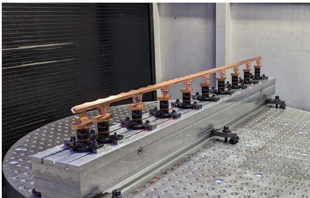
Abb. 8: RFQ-Elektrodenfertigung bei der Firma NTG GmbH.
